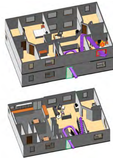
(d) Compartmented Fire Ventilation Profile
