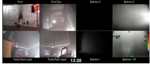
(d) Compartmented Fire (Bed 3) 30s After Fan On
